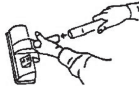
Postavljanje pribora na izvlačnu cijev
